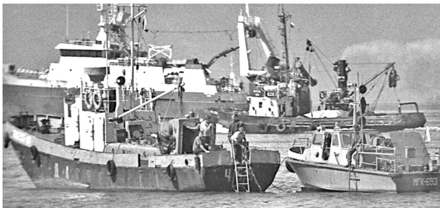
Авачинская губа. Гидрографы 111-го ЭГО на малом гидрографическом катере МГК-693 проекта 16830 обеспечивают водолазное обследование подводного препятствия, обнаруженного при промере на акватории рыбного порта
