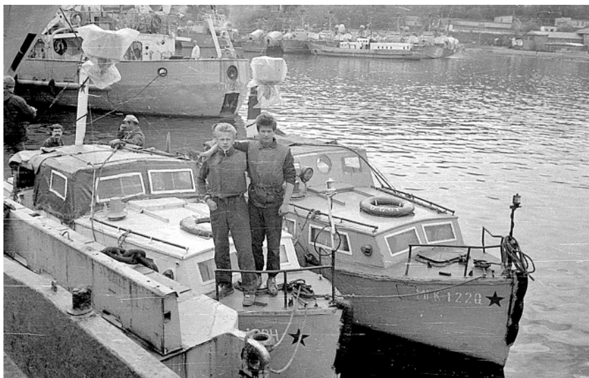
Бухточка Озеро Богородское. Авачинская губа. Малые гидрографические катера 111-го ЭГО МГК-1220 и МГК-1284 проекта 382КМ, оснащённые корабельной аппаратурой РНС «ГРАС», в готовности к выходу в море на промерные работы
