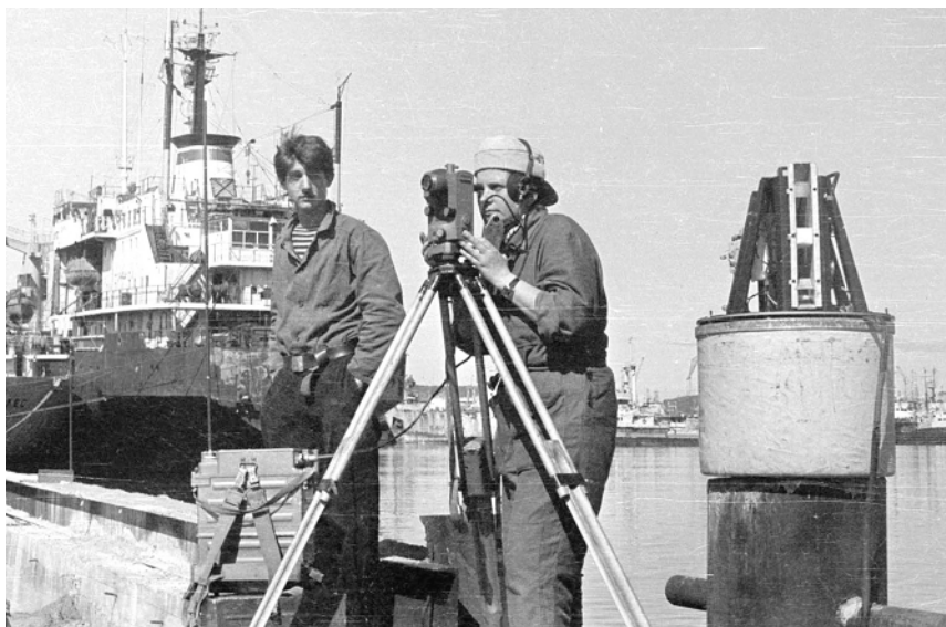
Авачинская губа. Инженер 111-го ЭГО Марина Лукашенко координирует местоположение гидрографического катера на промерном галсе с помощью теодолита и радионавигационной системы «ГРАС»
